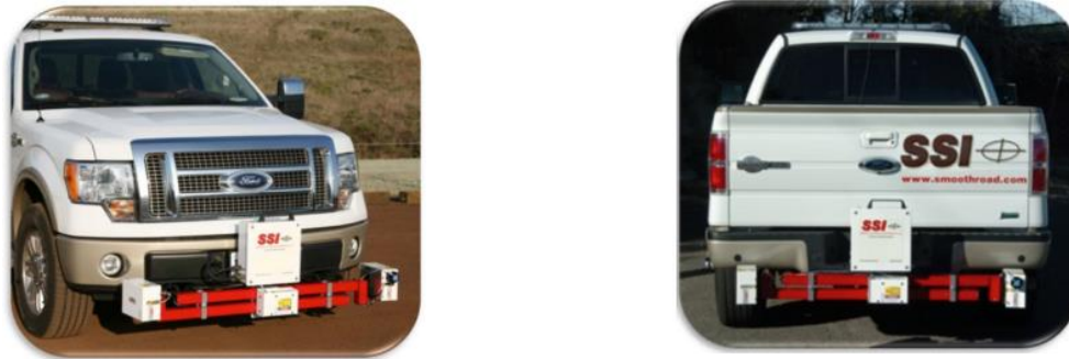
Figura 3 – Exemplos de fixação de perfilômetros inerciais (Fonte SSI®) a) fixação na dianteira b) fixação na traseira
