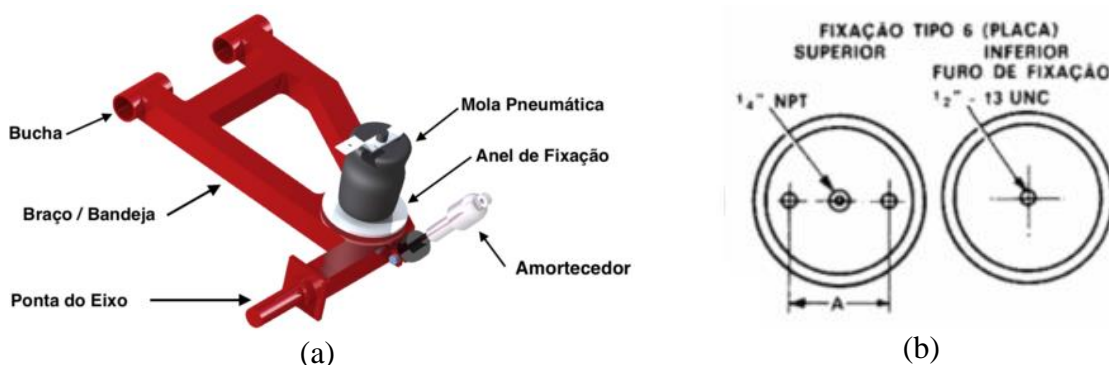
Figura 10 – Suspensão trailing arms do perfilômetro inercial rebocável a) modelo CAD b) anel de fixação da mola (Fonte: http://www.niagara.com.br/v2/comercial/firestone01.htm )
