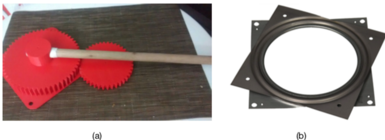
Figura 2: (a) Sistema de polias feito em impressora 3D (b) Rolamento
