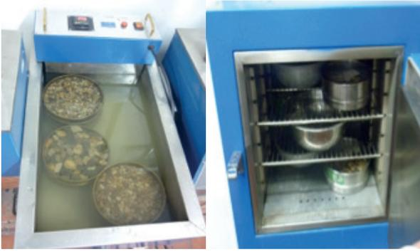
**Figura 1.** Inmersión y secado del material
