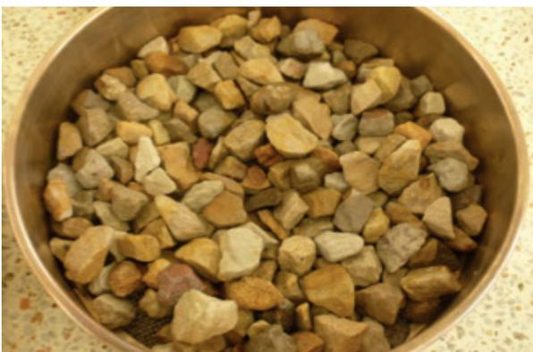
**Figura 4.** Agregado 1/2" Cantera Vista Hermosa (Mosquera)
