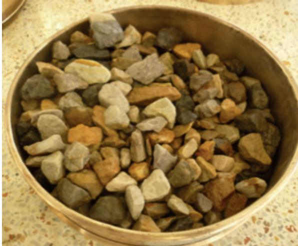
**Figura 6.** Agregado 1/2" Mina Cemex (Apulo)
