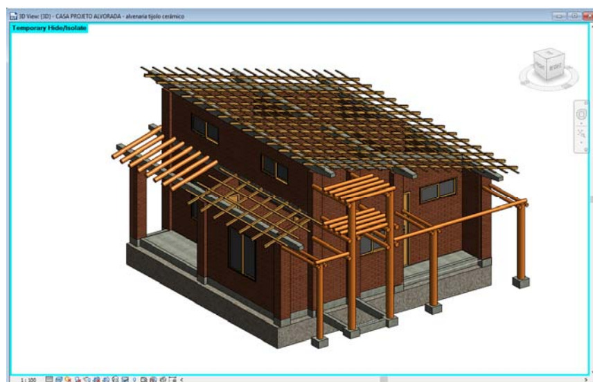
Figura 3: Estruturas em madeira da edificação.
