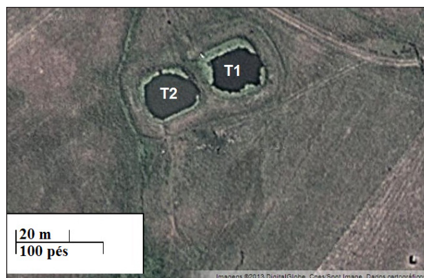
Figura 1: Vista aérea dos tanques de estabilização em série, localizados na UNIPAMPA, Campus Uruguiana visualizados a partir da imagem Google Earth
