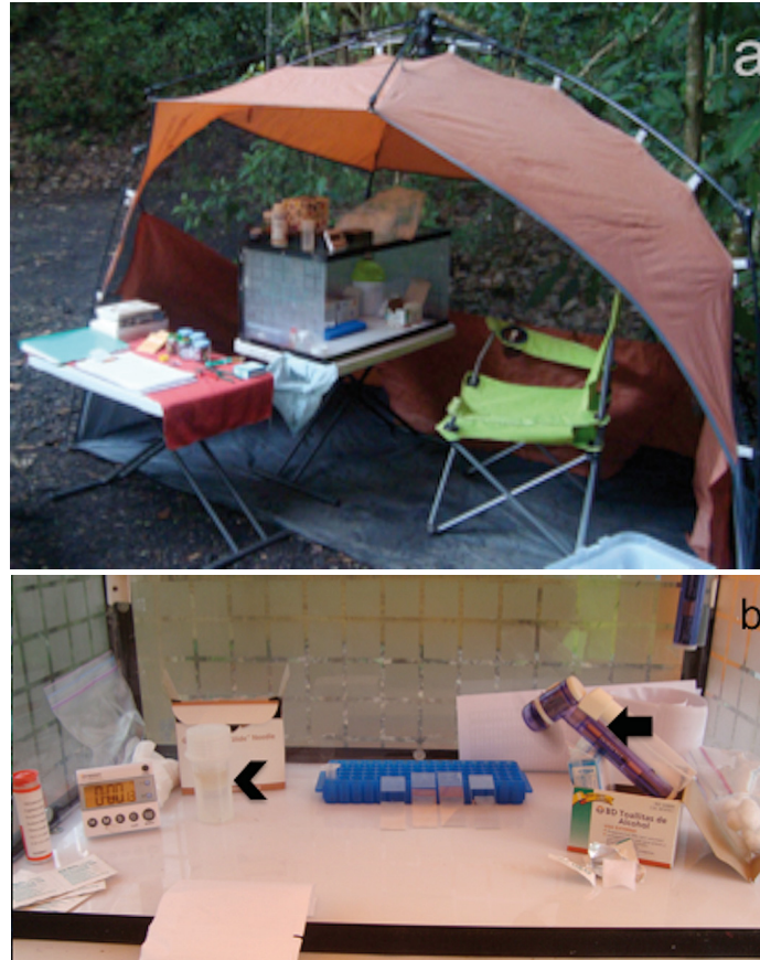
FIG. 1. a) Estación de campo y b) Equipo necesario para la preparación de frotis sanguíneos; contenedor Coplin de plástico con metanol absoluto para fijar los frotis sanguíneos (cabeza de flecha) y ventilador de baterías portátil (flecha). Fotografías por Diego Santiago-Alarcon.
