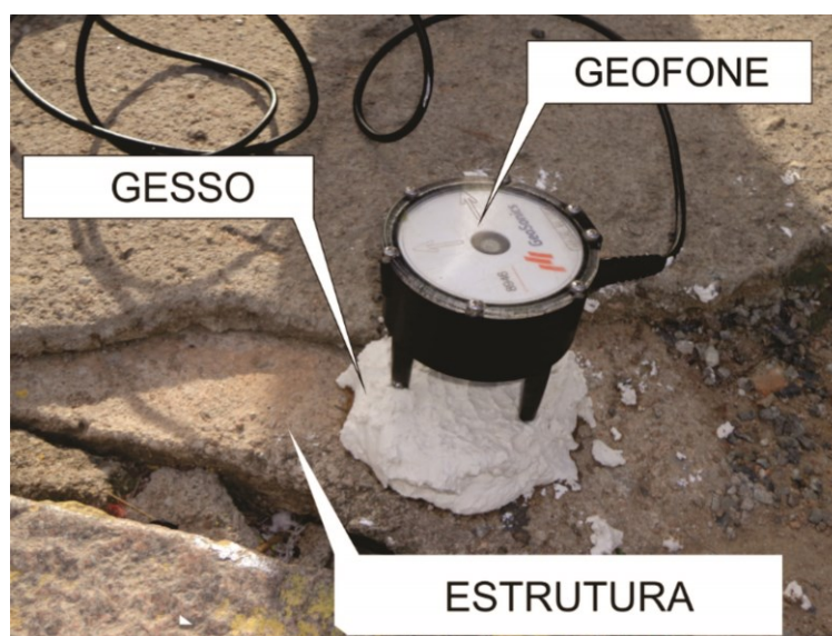
Figura 8 - Geofone instalado junto a estrutura, com o auxílio de Gesso.
