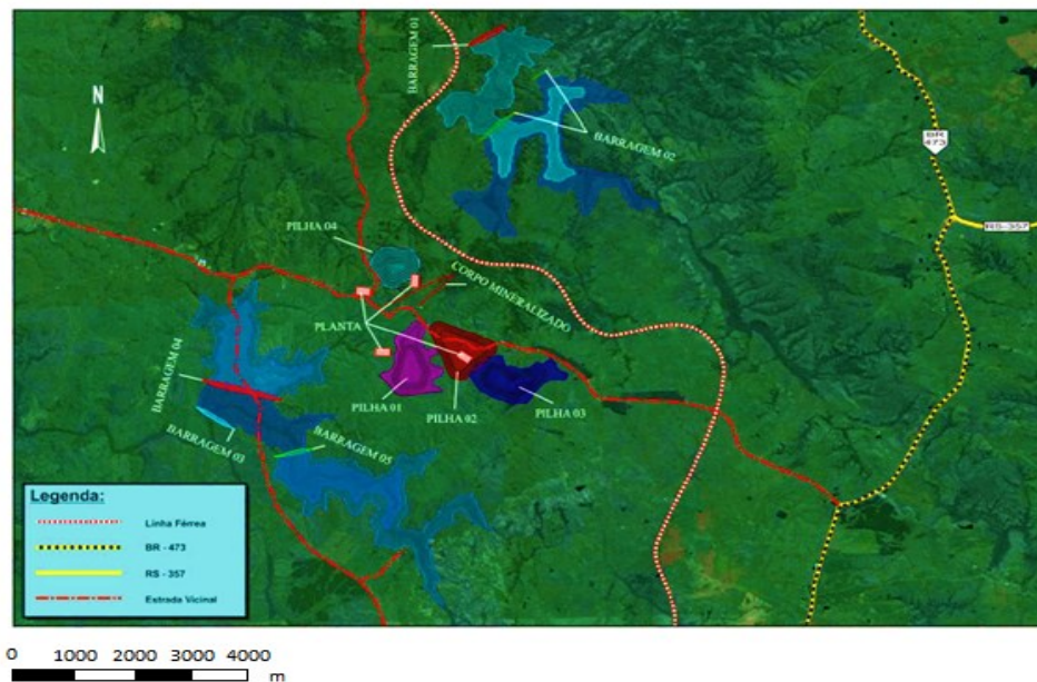
Figura 4: Plano diretor para a disposição do estéril e barragens de rejeito (fonte: Águia Resources, Volume II – Estudos Geotécnicos e Hidrogeológicos).
