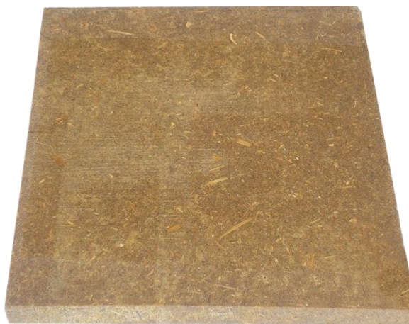
Figura 3 – Chapa recomposta de bambu fabricada com adesivo poliuretânico. Fonte: Autor (2012).
