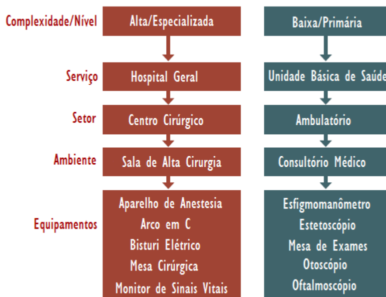
Figura 1 -Distribuição hierarquizada de equipamentos por tipo de serviço, setor e ambiente.
