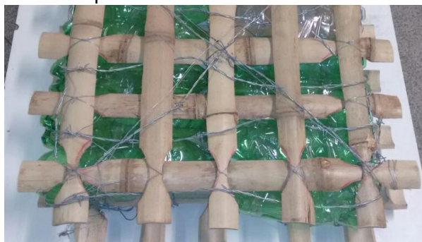
Figura 2. Técnica do bambu enrolado com arame farpado
