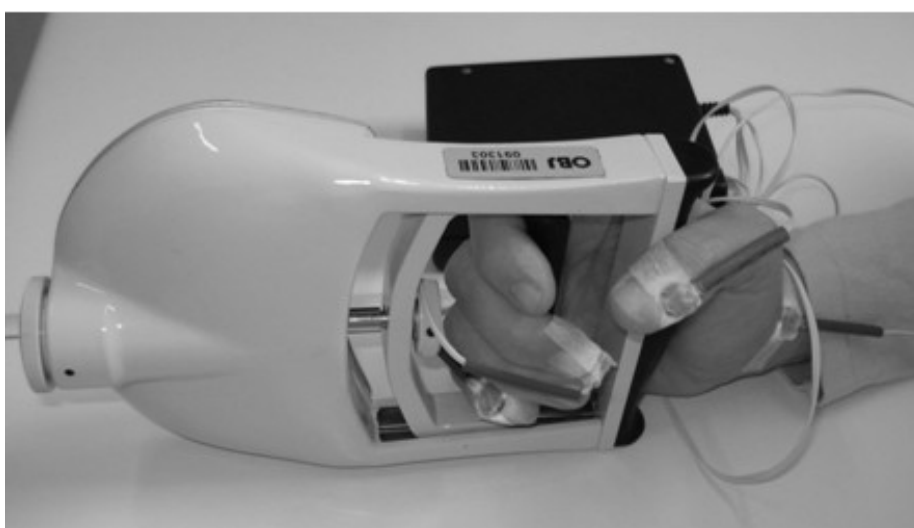
Figura 2 — Fixação dos quatro LEDs em posição de teste.
