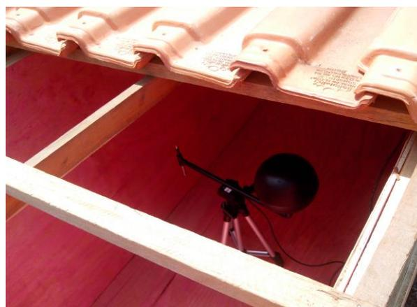
**Figura 9.** Confortímetro dentro do protótipo.
