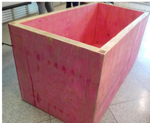
**Figura 3.** Protótipo 2:1 montado com placas de madeirite.
