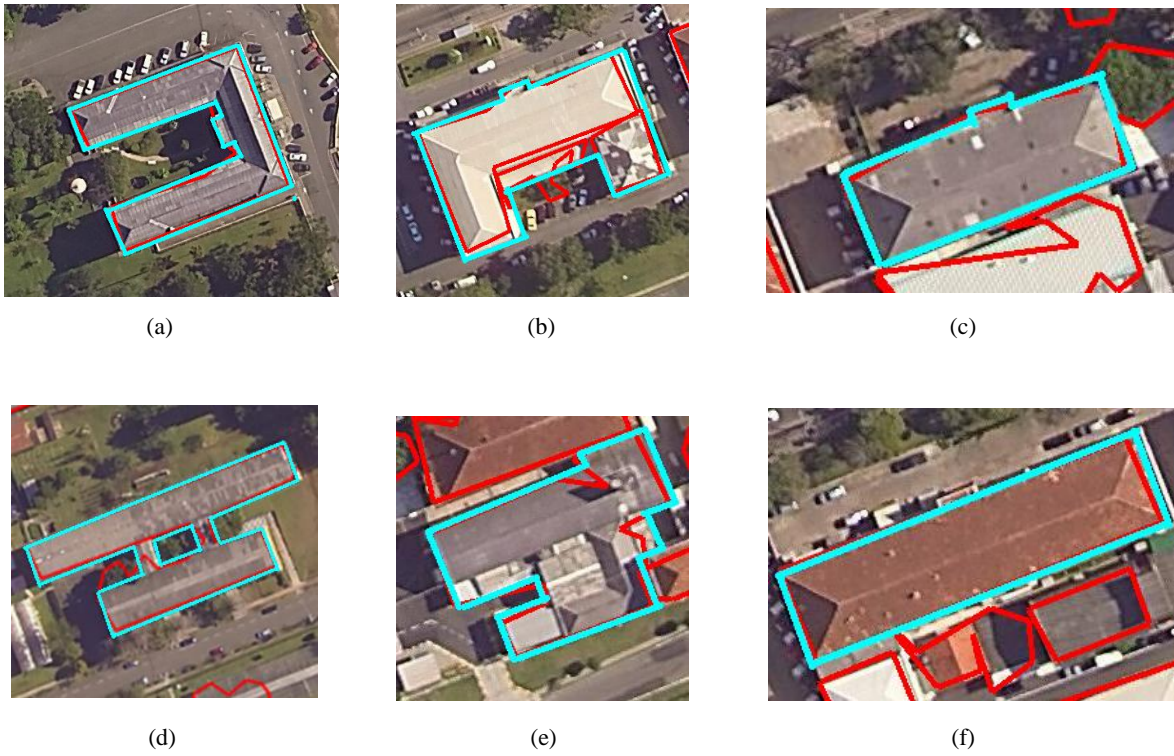
Figura 14. Resultado da extração de telhados.
