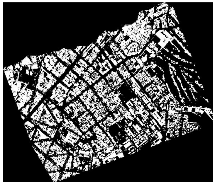
Figura 9. Imagem binária da grade, dos pontos considerados não pertencentes ao terreno, após a aplicação do método de filtragem (Algoritmo 3).
