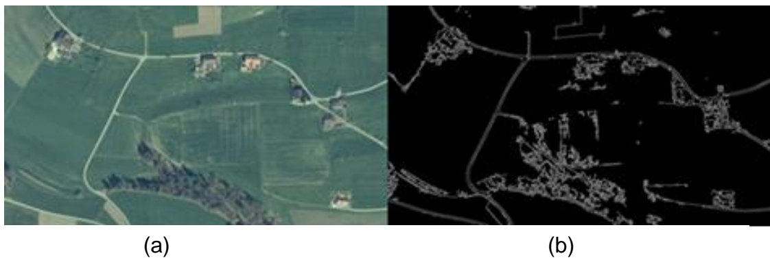
Figura 16. (a) Imagem de Entrada, (b) Imagem Base após aplicação da detecção de Bordas (Canny).
