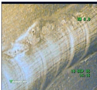
Gambar 1. Porositas pada bagian pengelasan bejana reaktor TRI-GA2000 [9]
