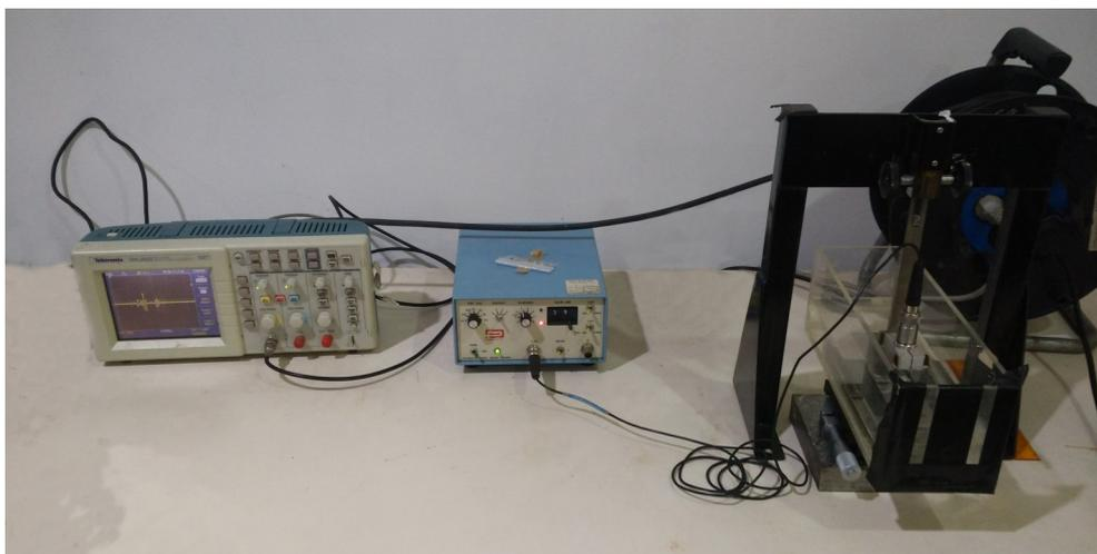
Gambar 1 Alat *ultrasonic water immersion* untuk visualisasi *nugget* las titik
