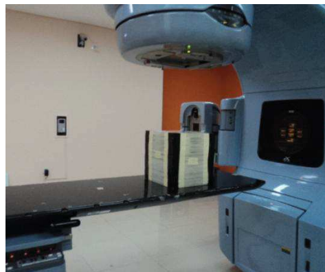
Gambar 3. Seting penyinaran fantom padat yang berisi foil indium pada titik isocenter dengan SSD 100 cm dan posisi gantri ke bawah.
