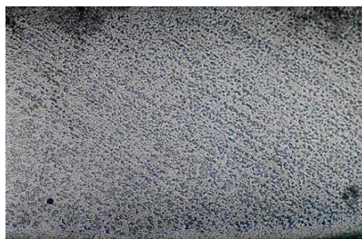
Gambar 17. Nitrocarburizing 650°C dengan Pembesaran 100×
