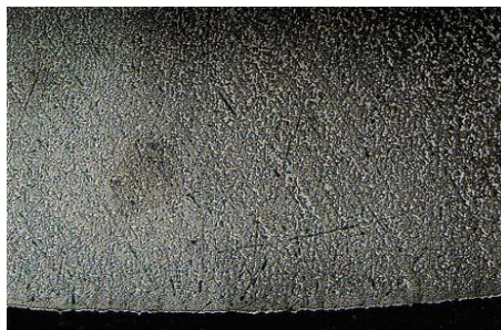
Gambar 15. Nitrocarburizing 600°C dengan Pembesaran 100×
