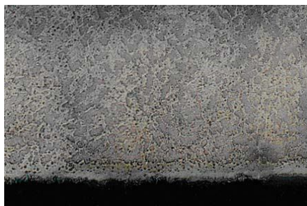
Gambar 14. Nitrocarburizing 550°C dengan Pembesaran 500×
