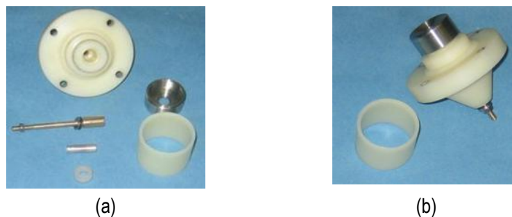
Gambar 6. (a). Komponen sistem elektrode ignitor, dan (b). Komponen sistem elektrode ignitor yang telah dirangkai menjadi satu modul sistem elektrode ignitor.
