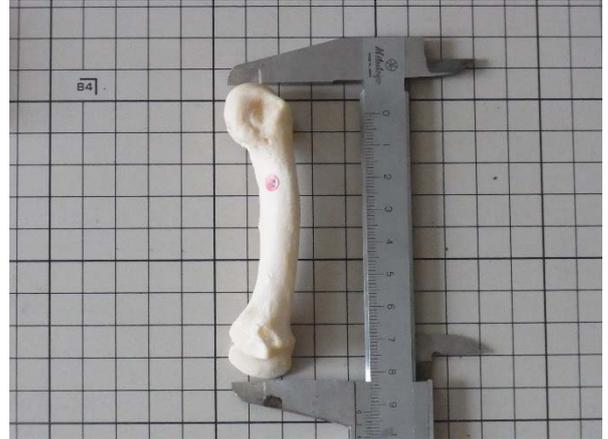
図 15 ノギスでの計測
