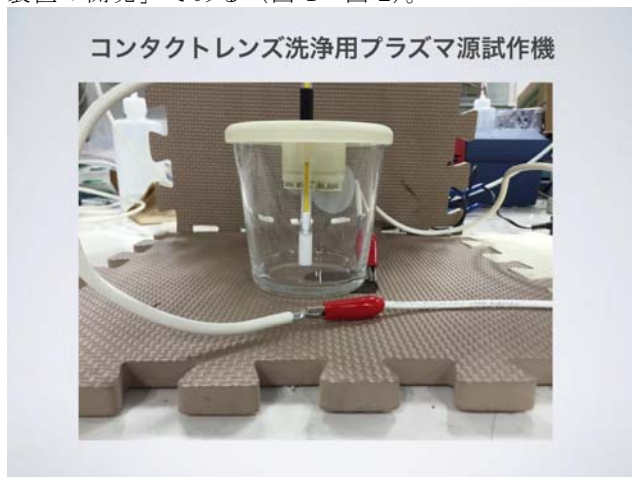
図1: 実験装置部分・器の中心にプラズマ発生装置
