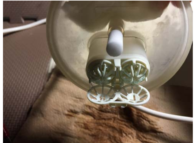
図2: 実験装置部分・バスケット内にコンタクトレンズを装着
