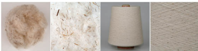
図2) 紡績工程2（原綿、混合したもの、紡績、拡大図）
