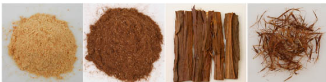
図1) 紡績工程1（おが粉と表皮の0.5mmメッシュ粉碎したものの、原材料の檜皮、檜皮の開織したもの）
