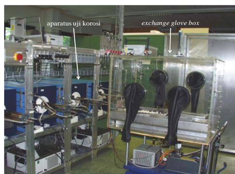
Gambar 1. Peralatan uji korosi cairan *lead-bismuth eutectic* dan *exchange glove box*.
