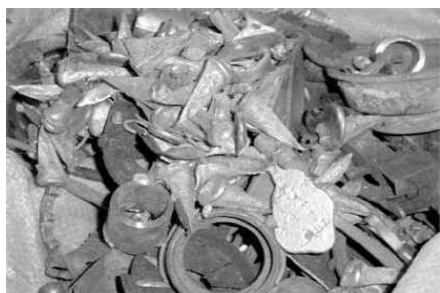
Gambar 2. Skrap lokal sebagai bahan baku pengecoran kuningan di industri kecil Indonesia.
