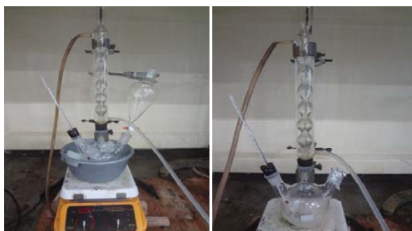
Gambar 1. Skema alat pencampuran pada suhu 0 °C (kiri) dan suhu tinggi (kanan).
