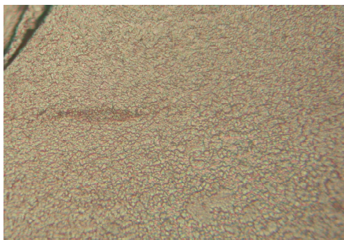
Gambar 11. (d). Struktur mikro kawat tembaga Ø 0,25 mm (A1) dan tanpa annealing akhir (TA2)
