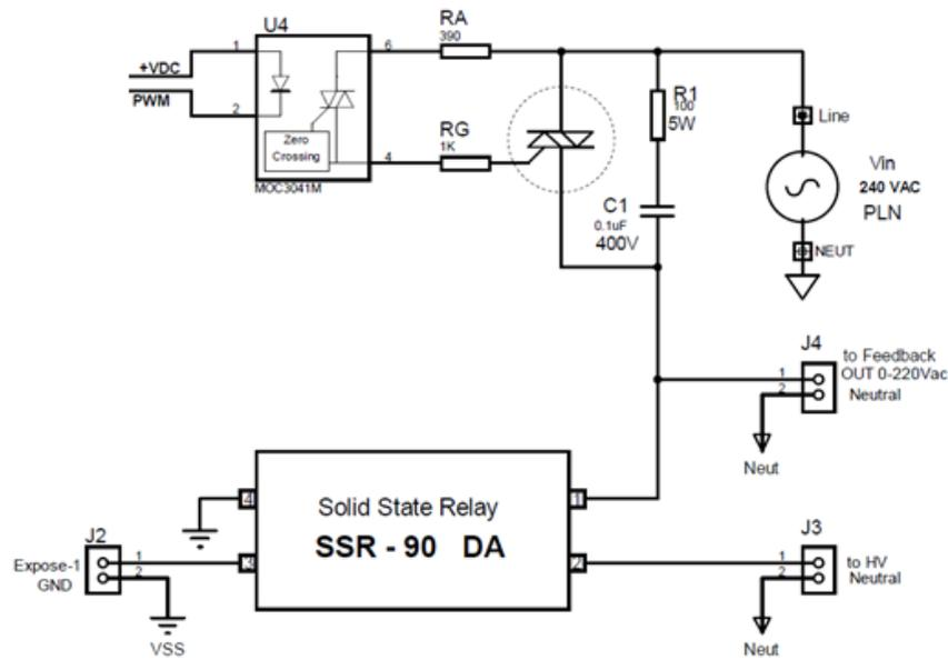
Gambar 7. Blok diagram modul SCR dan SSR.
