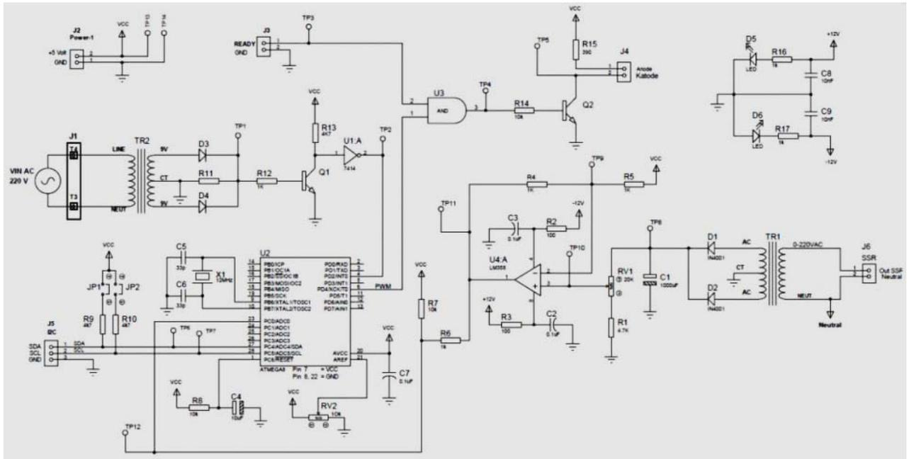
Gambar 8. Diagram skematik modul pengatur catu daya tegangan tinggi.
