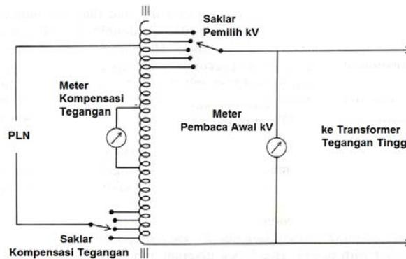
Gambar 2. Rangkaian pengatur tegangan tinggi perangkat mammografi konvensional
