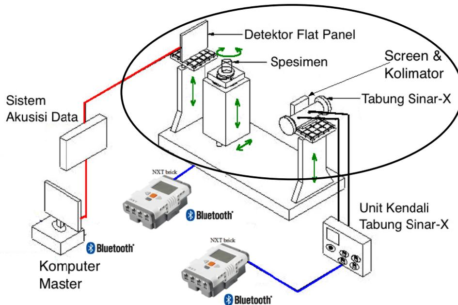
Gambar 1<sup>[1]</sup>. Bagan Sistem Perangkat Digital Radiografi Untuk Industri
