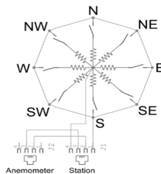
Gambar 7. Rangkaian Sensor Arah Angin<sup>[7]</sup>.
