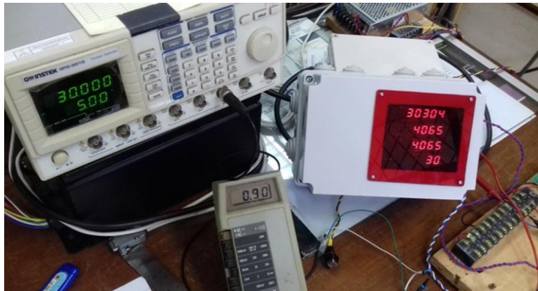
Gambar 8. Pengujian modul transmitter sinyal 4-20 mA, diinjeksi oleh kalibrator sinyal TTL
