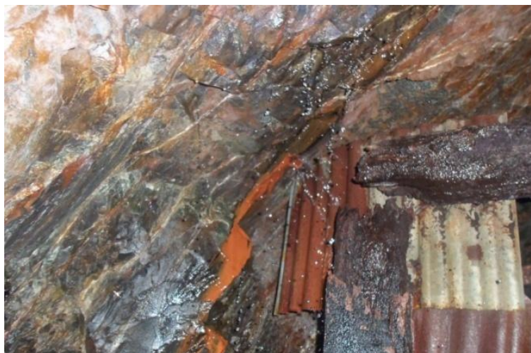
Gambar 7. Aliran airtanah pada rekahan di LP1.
