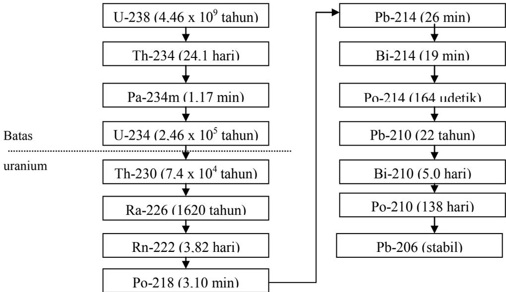
Gambar 1. Peluruhan radioaktif U-238 <sup>[5]</sup>
