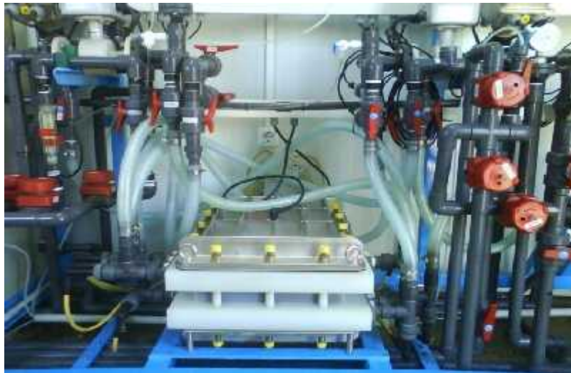
Gambar 2. Instalasi proses pemurnian uranium dari air laut menggunakan metoda elektrodialisis sistem barrier [16-17]
