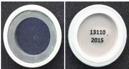
Gambar 5. Standar sekunder isotop ^{137}\text{Cs} dalam sumber tertutup shield sources dengan aktivitas 10330 \pm 411 \text{ Bq}
