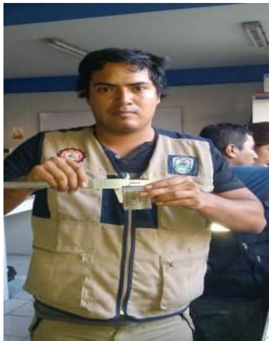
Figura 18: Medicion diámetros de cubos de morteros
