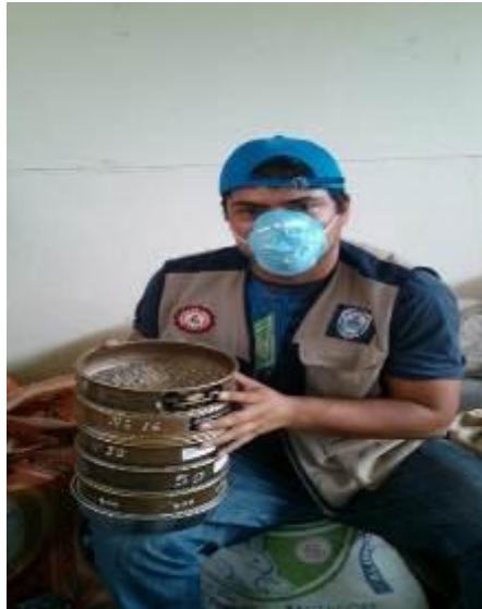
Figura 09: Se empieza a gradar la arena manufacturada por las mallas
