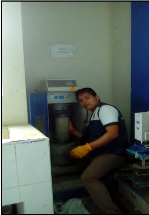
FIGURA N° 59: Ensayo de resistencia a la compresión para un curado de 14 días.
