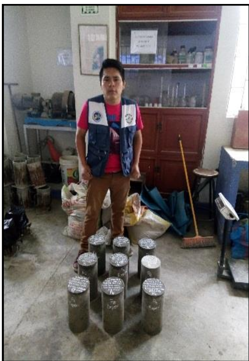
FIGURA N° 55: Una vez la mezcla en el molde, finalizamos con un buen acabado y al día siguiente desmoldamos.
