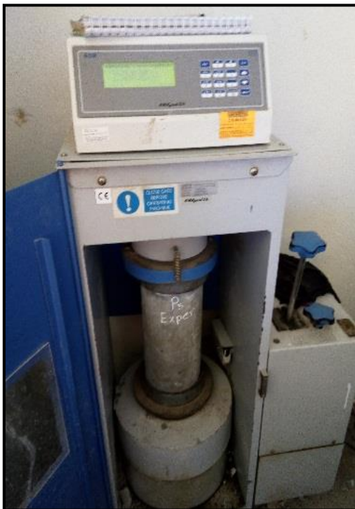
FIGURA N° 64: Ensayo de resistencia a la compresión para un curado de 14 días.
