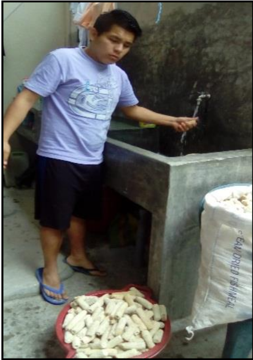
FIGURA N° 17: Lavado nuestro material, para evitar el polvo o la suciedad en la que se adquiere y así realizar un buen ensayo de FRX.
