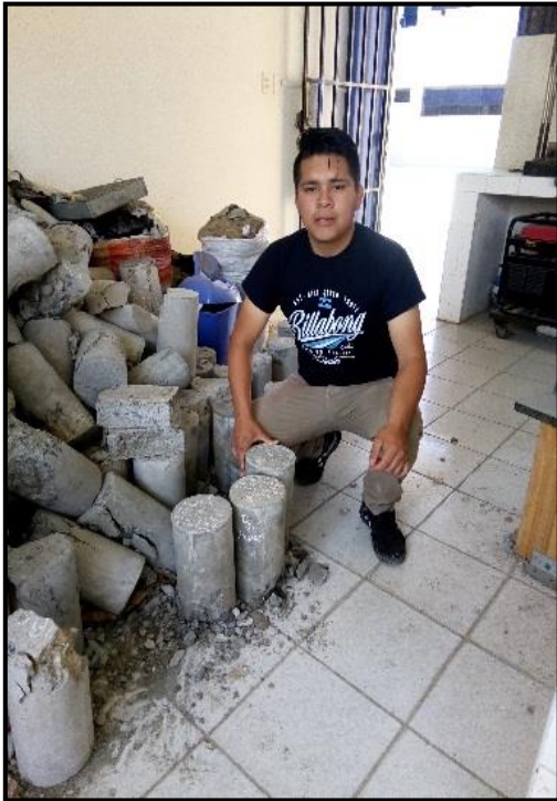
FIGURA N° 65: 3 probeta de concreto sometido a ensayo de resistencia a la compresión.
