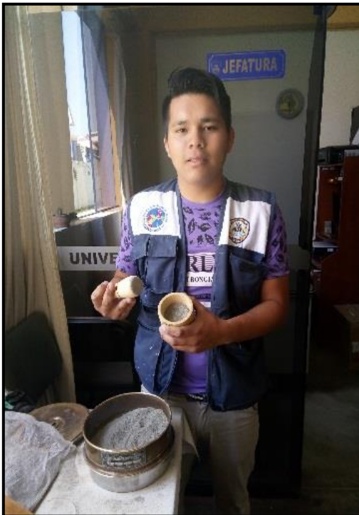
FIGURA N° 38: Luego de haber calcinado y enfriando, con un mortero molemos la ceniza de cola de caballo hasta que pase por la malla #200, listo para ser empleado.
