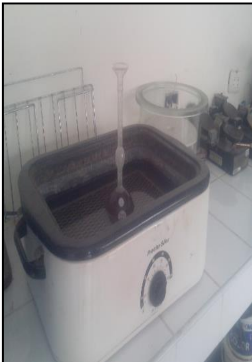
FIGURA N° 48: Realizamos el ensayo de Peso Específico del nuevo cemento sustituyendo el 10% de ceniza de tusa de maíz y 5% de ceniza de cola de caballo por cemento, obteniendo un nuevo diseño de mezcla para las probetas experimentales.
