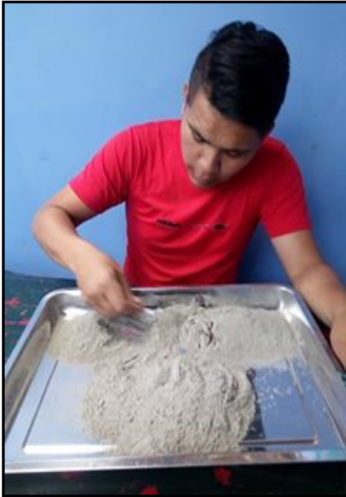
FIGURA N° 49: Para obtener nuestro nuevo cemento con su nuevo diseño de mezcla se tiene que mezclar las tres muestras correspondientes a cada porcentaje según le corresponda.
