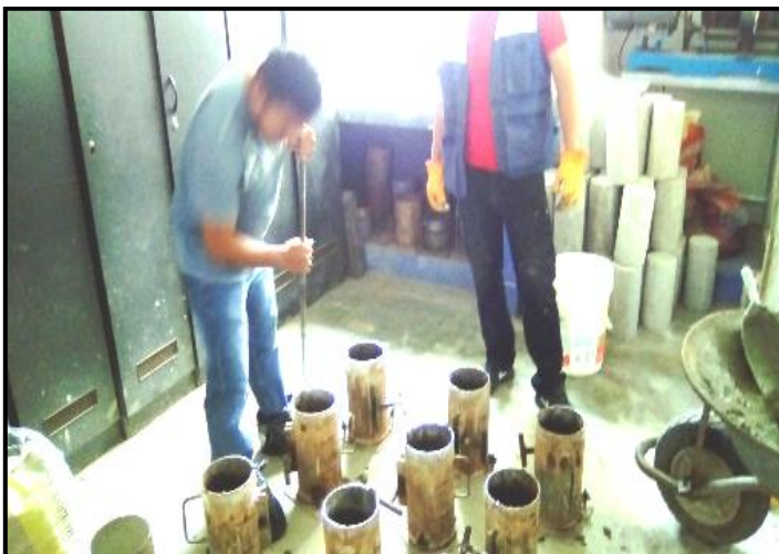
FIGURA N° 46: Una vez la mezcla en el molde, finalizamos con un buen acabado y al día siguiente desmoldamos.
