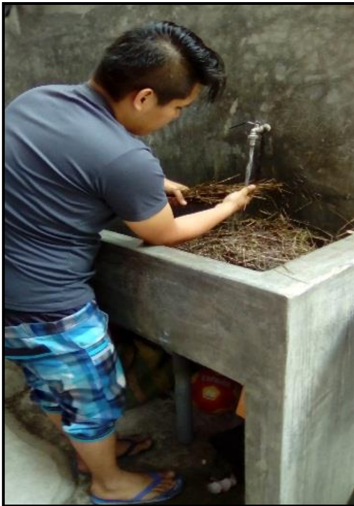
FIGURA N° 30: Realizaremos el lavado de nuestro material, para evitar el polvo, la suciedad con la que se encuentra, se adquiere totalmente sucio con exceso de pajas.
