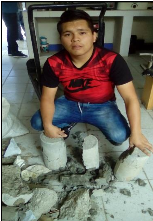
FIGURA N° 58: 3 probeta de concreto sometido a ensayo de resistencia a la compresión.
