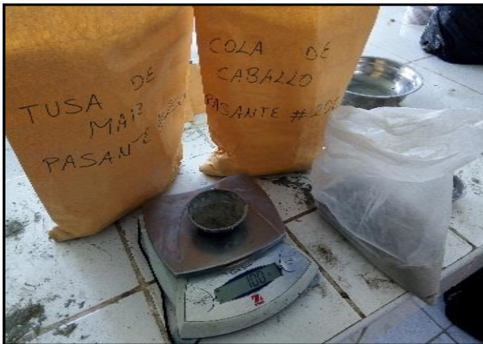
FIGURA N° 40: Realizar la alcalinidad de nuestra recalcinación pasante por la malla #200 de nuestra cola de caballo, mediante el ensayo de PH.
