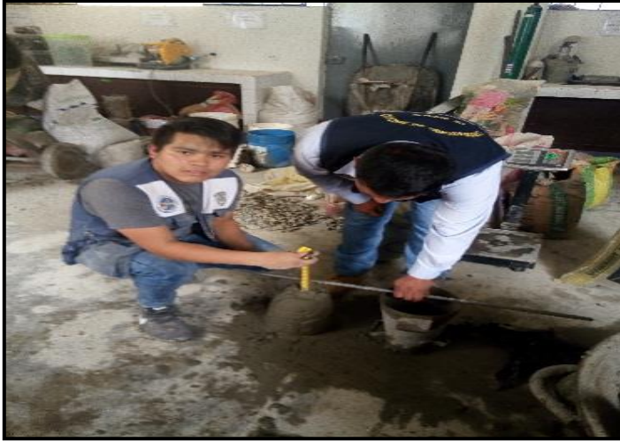
FIGURA N° 53: Realización de ensayo de slump.
