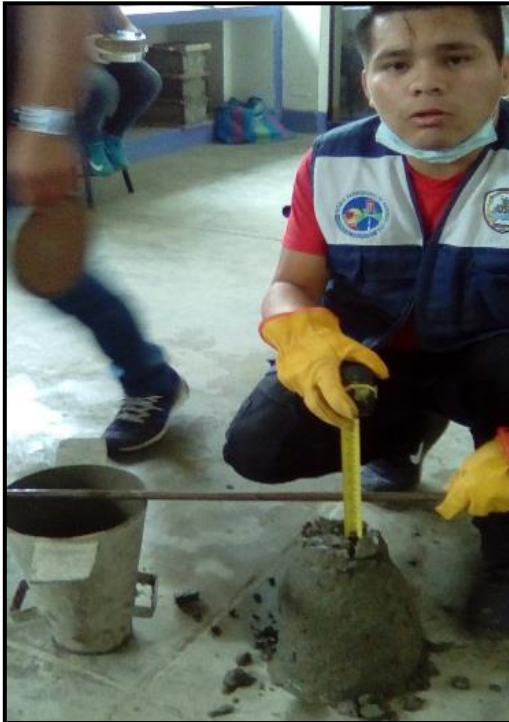
FIGURA N° 45: Luego de obtener la mezcla, se le realiza el ensayo de asentamiento de cono al concreto, siguiendo con el procedimiento pasamos a vaciar los moldes para empezar a chusear y golpear para evitar los vacíos.
