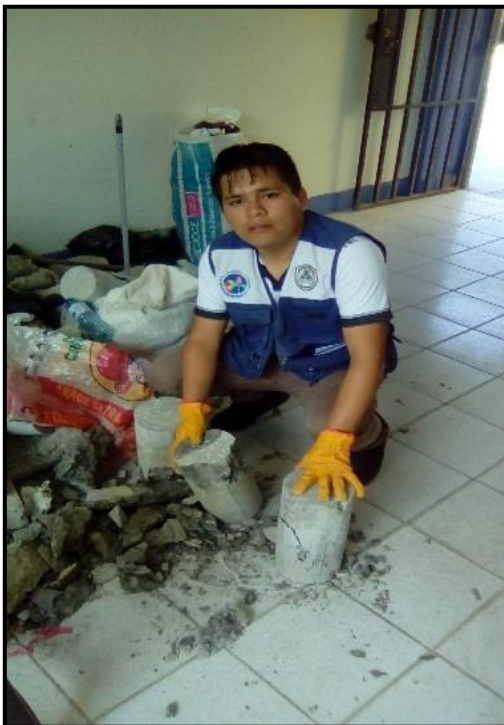
FIGURA N° 60: 3 probeta de concreto sometido a ensayo de resistencia a la compresión.
