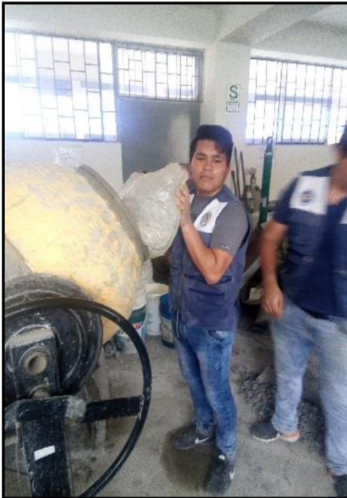
FIGURA N° 50: Una vez pesado los agregados introducimos en la mezcladora, para que así sea homogénea el mezclado de los materiales.
