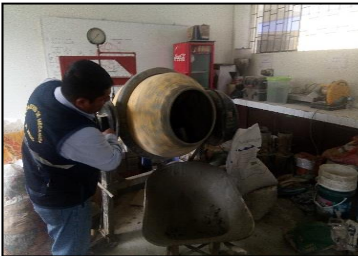
FIGURA N° 52: Luego de obtener la mezcla, se le realiza el ensayo de asentamiento de cono al concreto, siguiendo con el procedimiento pasamos a vaciar los moldes para empezar a chusear y golpear para evitar los vacíos.
