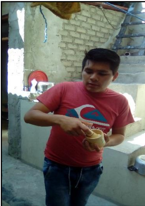
FIGURA N° 26: Luego de haber calcinado y enfriando, con un mortero molemos la ceniza de tusa de maíz hasta que pase por la malla #200, listo para ser empleado.
