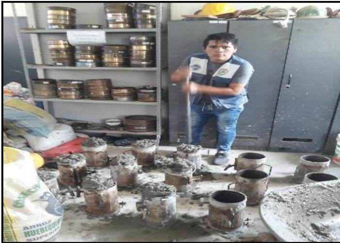
FIGURA N° 54: Llenado de mezcla de concreto a los moldes.
