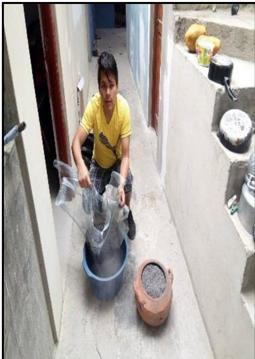
FIGURA N° 36: Luego de enfriar la ceniza, pasar por la malla organza y tener mucho mejor polvo tamizada de nuestra ceniza, ya que en el calcinado no se llega a obtener un buen fino de la ceniza, luego embolsar en bolsa de papel amarillo, preferible no exponerlo mucho tiempo expuesto al ambiente.
