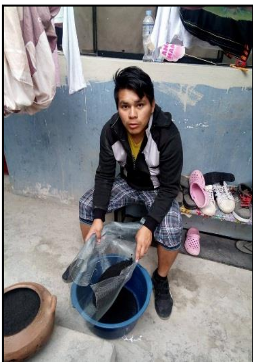
FIGURA N° 24: Luego de enfriar la ceniza, pasar por la malla organza y tener mucho mejor polvo tamizada de nuestra ceniza, ya que en el calcinado no se llega a obtener un buen fino de la ceniza, luego embolsar en bolsa de papel amarillo, preferible no exponerlo mucho tiempo expuesto al ambiente.
