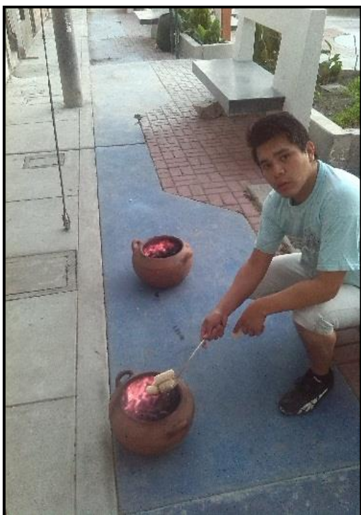
FIGURA N° 23: Proceso de calcinado a cielo abierto en ollas de barro para obtener nuestra ceniza de tusa de maíz.
