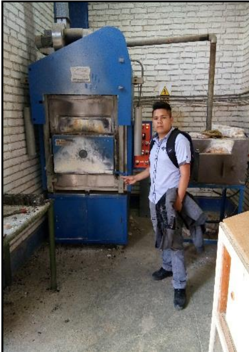
FIGURA N° 25: Proceso para recalcinación de la ceniza calcinada de la tusa de maíz a temperatura designada que se realizó mediante el ensayo de ATD. Se recalcinara la ceniza durante 3 horas como indica algunos artículos realizados internacionalmente.
