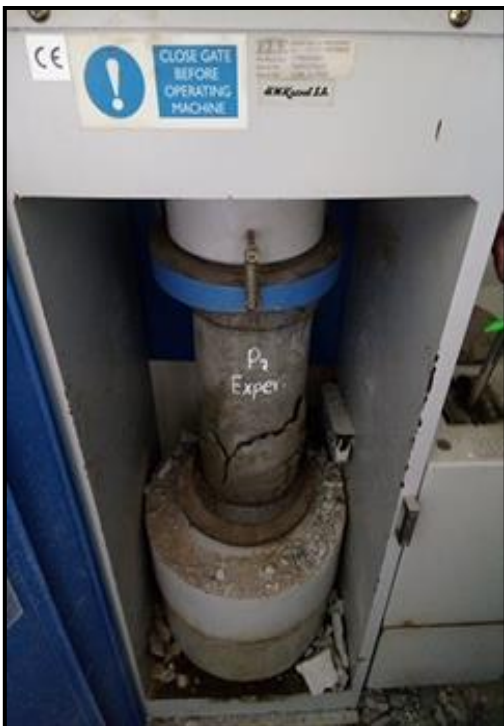
FIGURA N° 66: Ensayo de resistencia a la compresión para un curado de 28 días.
