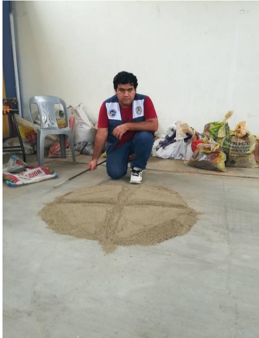
FOTO N° 3: Cuarteo de la arena para realizar el ensayo granulométrico
