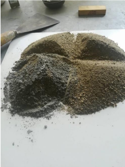
FOTO N° 11: Realizando el cuarteo y combinando la arena y cemento para la elaboración del mortero y el ensayo de fluidez
