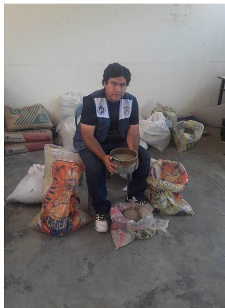
FOTO N° 4: Realizando la gradación
