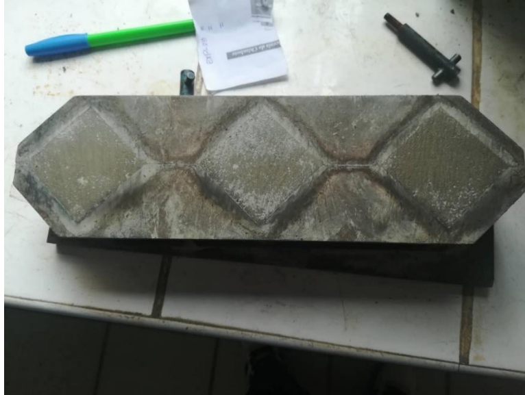
FOTO N° 13: Elaborando los dados de mortero patrón y experimentales
