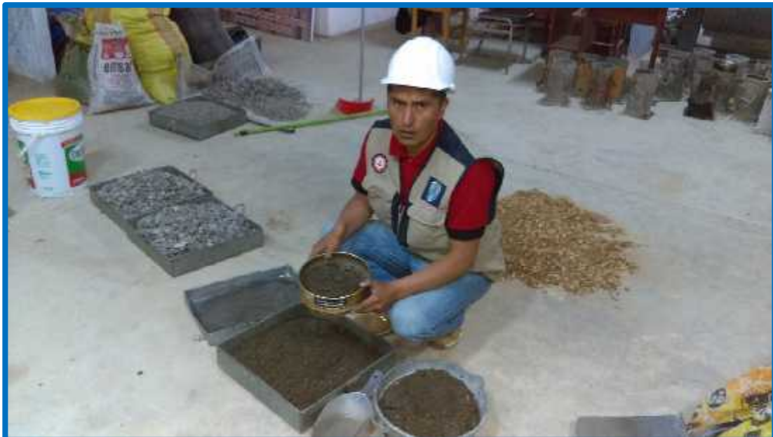
Foto 3 Tamizado de agregado fino
