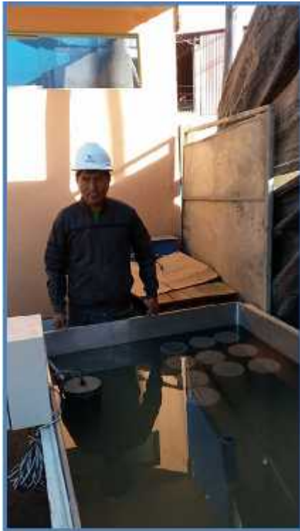
Foto 25 Curado de muestras de concreto
