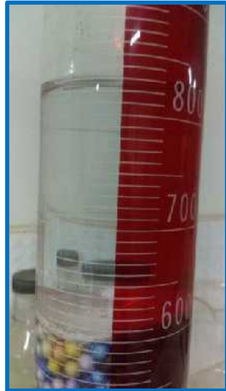
Foto 16 Ensayo con probeta para Pe.
