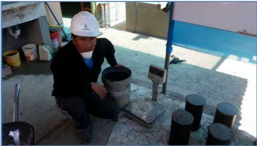
Foto 10 Pesado de agregados para diseño.
