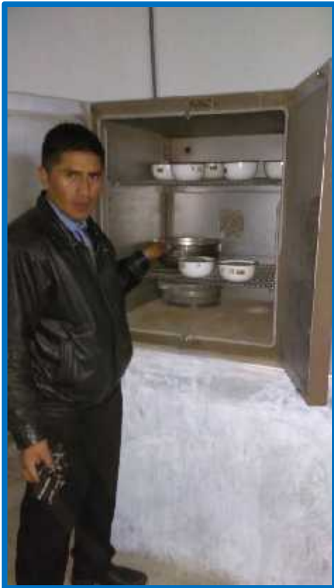
Foto 1 Secado en horno para contenido de humedad.
