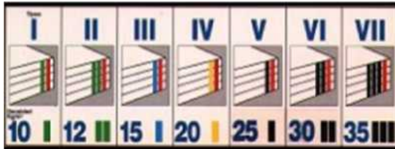
Figura N° 3 Clasificación de poliestireno expandido según su densidad Fuente: norma UNE 23727
