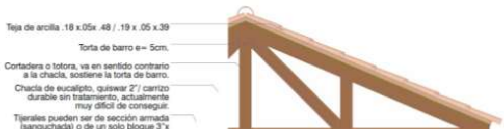
Figura 52: Corte detalle de techo con tejas.
