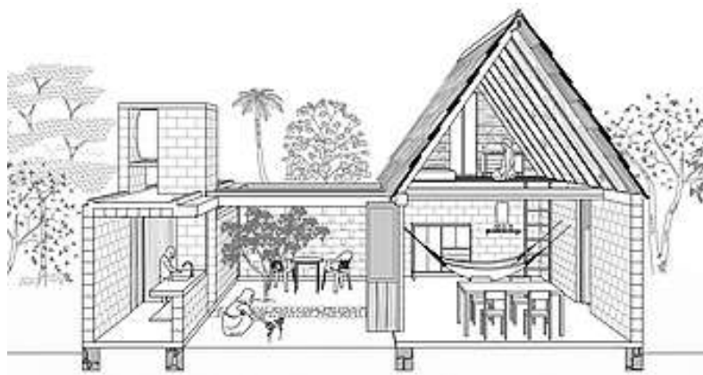
Figura 1: Corte transversal de la vivienda.
