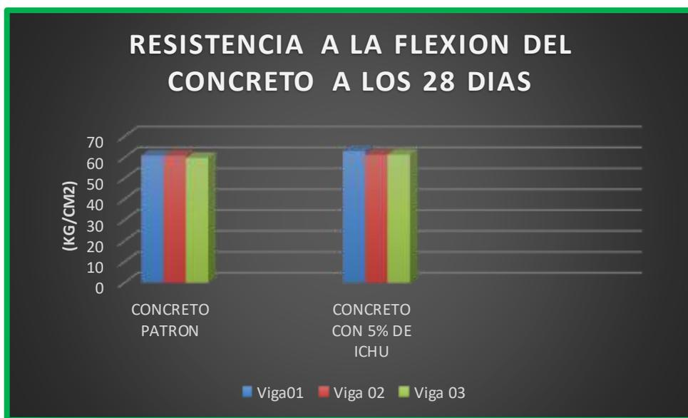
**Grafico N°12:** Ensayos de rotura a la flexión del concreto a los 28 días
