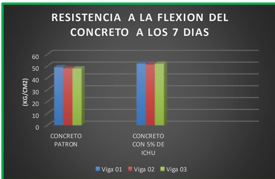
**Grafico N°10:** Ensayo de rotura a la flexión del concreto a los 7 días
