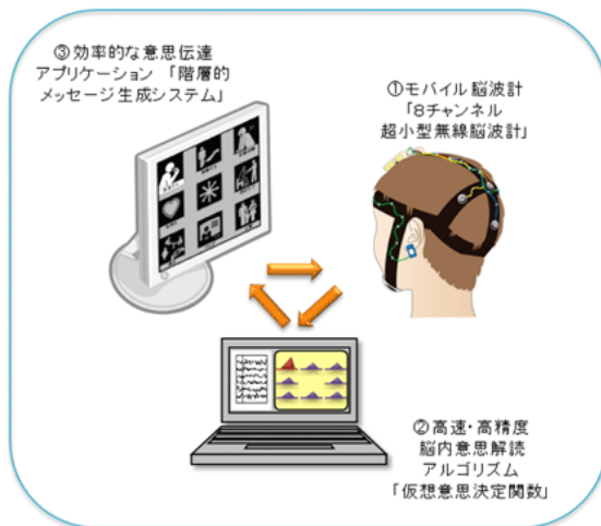
図 2-4 ブレイン-マシンインターフェース (BMI) システムの概要[3]. Fig. 2-4 Outline of BMI system [3].
