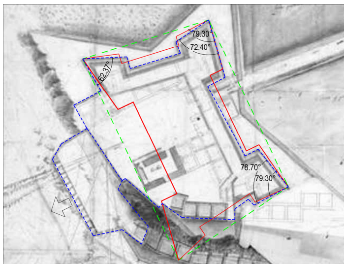
Ilustração 179 - Torre Velha. Amplitude dos ângulos dos baluartes. (desenho nossa autoria sobre imagem de carta GEAEM cota 2680-2A-25A-36).
