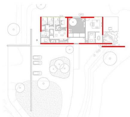
Ilustração 49 – Planta da Hooper House II, extensão de planos assinalados. ([Adaptado a partir de:] Nicasio, 2016)
