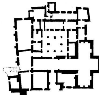
Ilustração 106 – Planta do piso 0 com a construção da segunda fase, por volta dos anos 40-50 do século XVI. ([Adaptado a partir de:] Rodrigues, Pereira e Carvalho, 2008, p. 48).
