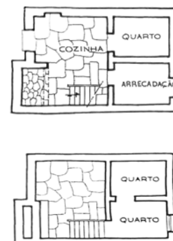
Ilustração 72 - Casa do Povoado de dois pisos: exemplo de plantas dos pisos térreo e superior. ([Adaptado a partir de:] Moutinho, 1995, p. 132)
