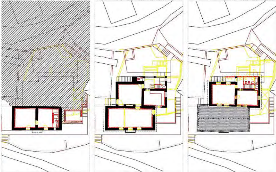
Ilustração 136 - Plantas de vermelhos/amarelos dos pisos -1, 0 e 1. André Eduardo Tavares, 2012. ([Adaptado a partir de:] Tavares, 2013, p. 5)
