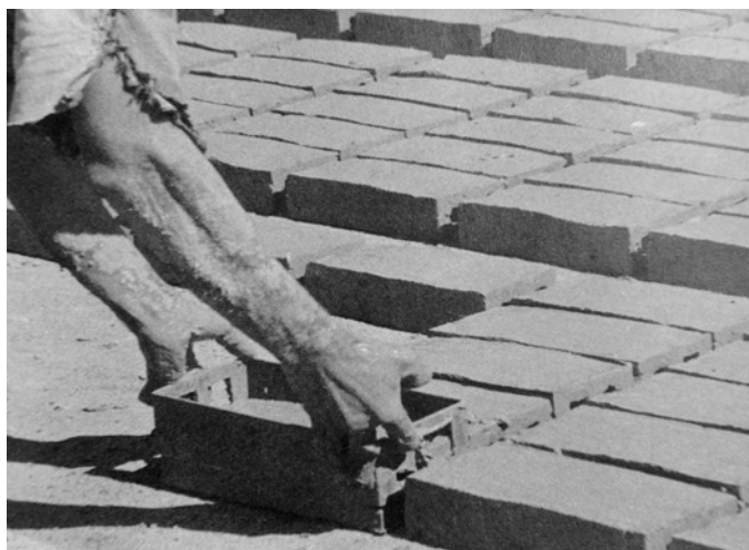
Ilustração 90 - Produção artesanal de adobe, Portimão. ([Adaptado a partir de:] Martins, Castro e Torres, 1988, p. 175)
