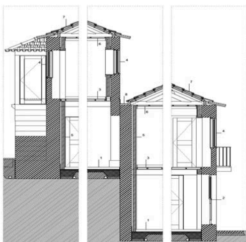
Ilustração 156 - Corte construtivo transversal B. André Eduardo Tavares, 2012. ([Adaptado a partir de:] Tavares, 2013, p. 23)
