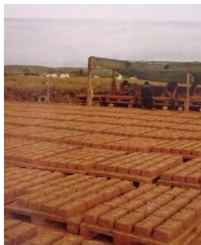
Ilustração 91 - Produção mecânica de adobe, Lagos. Mariana Correia, 2010. ([Adaptado a partir de:] Correia, 2010, p. 65)
