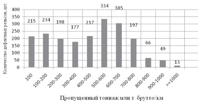
Рис. 1. Количество снятых дефектных рельсов по коду 10 с разбивкой по тоннажу на ГЖД в 2007 году.
