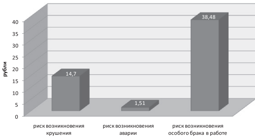
Рис. 2. Эколого-экономическая оценка риска для трех сценариев развития аварийного происшествия (грузовой поезд с дизельным топливом из 65 четырехосных вагонов-цистерн).
