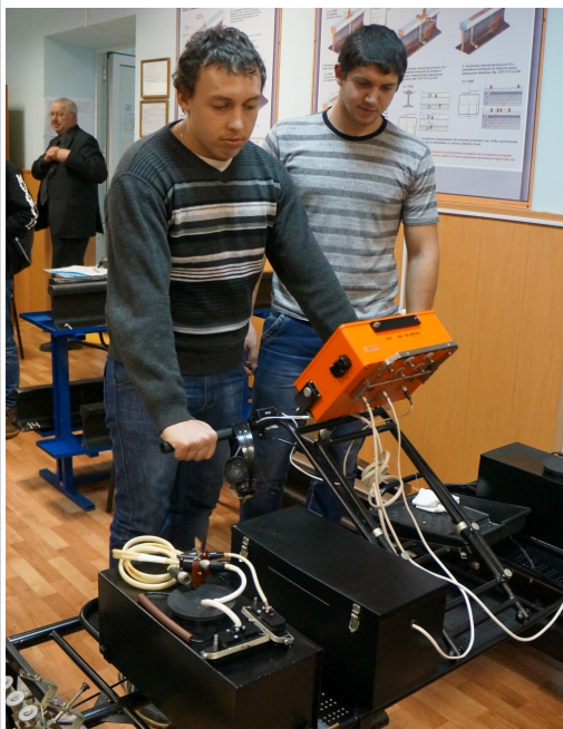
Рис. 5. Выявление дефектов двуниточным дефектоскопом Авикон-11 в «контрольном тупике».
