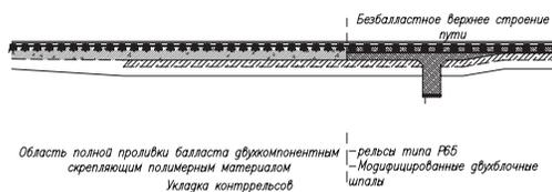
Рис. 3. Конструкция УПЖ с балластной призмой, омоноличенной вяжущими материалами.
